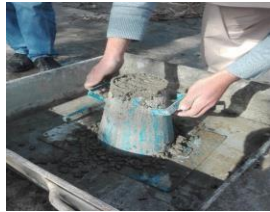
(3.1.1) Slump Test test
